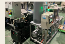
「バブパワー 2」と精密ろ過装置
