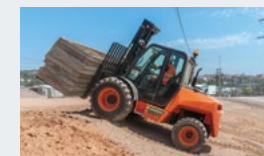
不整地走行に適したAUSA（スペイン）のタイヤ式フォークリフト
