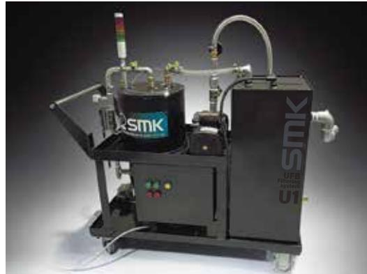
手元操作スイッチで、複雑な操作は一切なし。ポンプの稼働状況や異常はパトランプで監視。また、何らかのトラブルでフィルタハウジング内が一定の圧力を超えた場合や液漏れが発生した場合には、センサーが異常を検知し自動停止。万が一液漏れが発生しても、外に流れ出ないような筐体設計。
