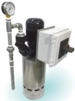
精密濾過装置 SMK RAPTOR シリーズに、水溶性クーラント専用マイクロファインバブル発生装置「バブパワー」を搭載した新型モデルが誕生。平均直径 100 ナノメートル（ナノは 10 億分の 1）の超微細マイクロファインバブルが消滅する際に発生する活性酸素の消毒機能により、クーラント液の劣化を抑止。クーラント液 1cc 中にマイクロファインバブルを約 1 億 4000 万個含む。これまでの濾過性能に加え、加工精度や洗浄性を高め、隙間に泡が入ることで接触面の抵抗を減らすことが可能になる。工具の長寿命化や切削速度の向上といった効果も期待できる。
