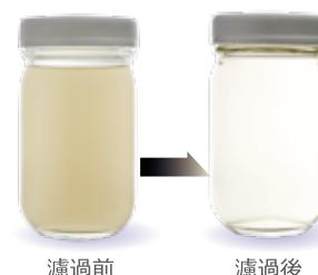
スラッジなどクーラント液中の砥粒を取り除き混濁を解消します。
