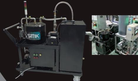
平均0.1μサイズの微細気泡を安定発生させるための精密濾過機能付きとなっており、加工中の洗浄性を高めると同時に加工効率をUPさせることができる。
