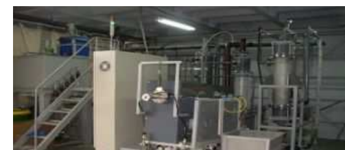
専焼型破壊設備の例 （フロンJCMによりR2年度にベトナムに導入済）
