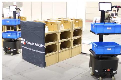
物流倉庫用のピッキングアシストロボットで自動化を提案 (Rapyuta Robotics製)
