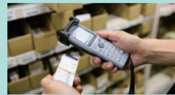
ピッキング、梱包、検品、出荷の計4工程で商品バーコードを使いデータを可視化しています。
