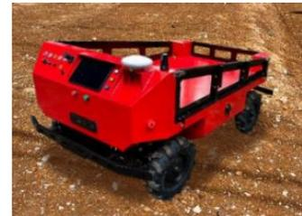
不整地や段差・20度までの斜度に対応できる自動走行&追従ロボット。資材運搬の省人化に貢献。
