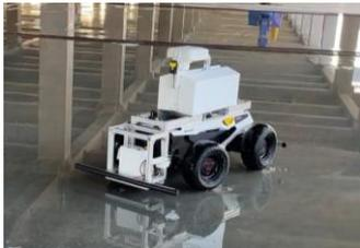
散水養生中のコンクリート表面の湿潤状態を検知できるロボット及び、散水システムを開発。コンクリート散水養生における省人化・データ記録化を実現。
