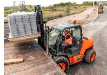
不整地にも対応できる4輪駆動式フォークリフト。2.5トンまで持ち上げ、ジョイスティックで直観的に操作可能。
