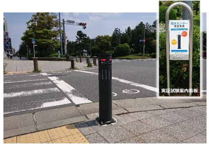
浦安市内に設置された冠水センサー付きポラード
